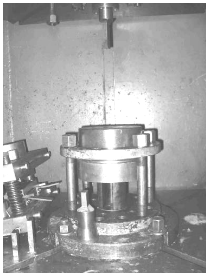
Рис. 3.4. Внешний вид и характеристики установки для холодной ВЭ по схеме механической экструзии
