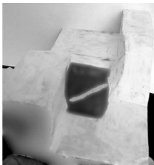
Рис. 2.1. Половина разборной гипсовой матрицы для моделирования ВЭ
