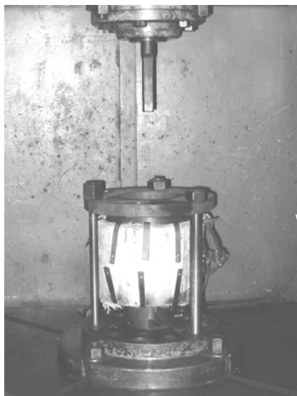
Рис. 3.5. Внешний вид и характеристики установки для теплой ВЭ по схеме механической экструзии
