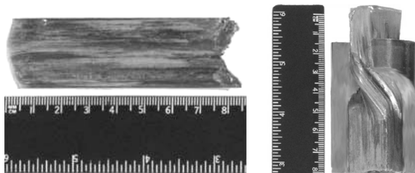
Рис. 2.4. Заготовка меди после винтовой экструзии. Искаженные торцы заготовки показывают, что в ходе процесса происходит депланация сечений, ортогональных ее оси
